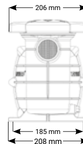
Salida en 50 mm y adaptadores cónicos \varnothing 32/38 mm
