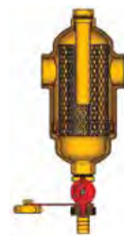
Esquema montaje accesorio: Desfangador + Sep. magnético
