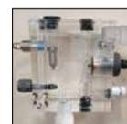
Sonda amperométrica para cloro libre
